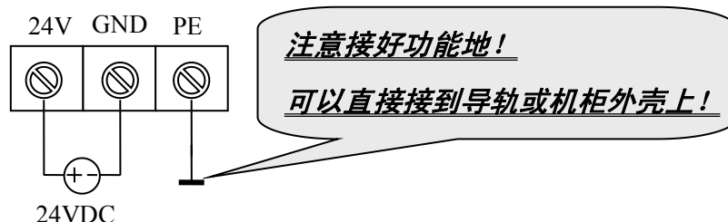
图 2-1 DS300A 一体化 IO 电源端子图
