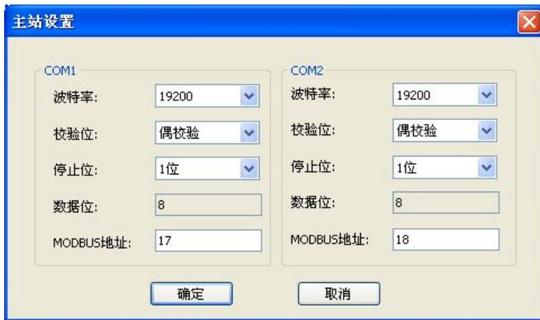
图 4-13 网关串口侧的参数配置
