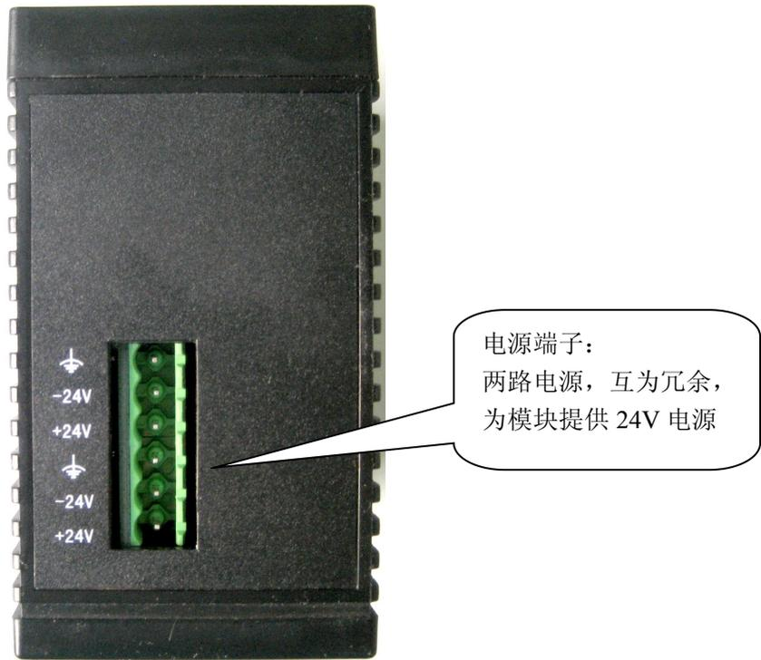
图 2-2 ETH-485-MRTU2 顶部图
