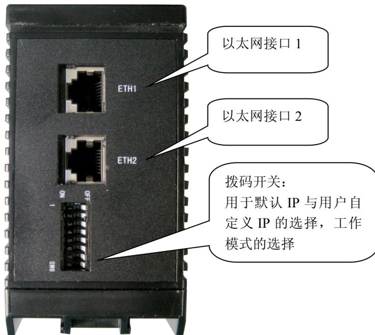
图 2-3 ETH-485-MRTU2 底部图
