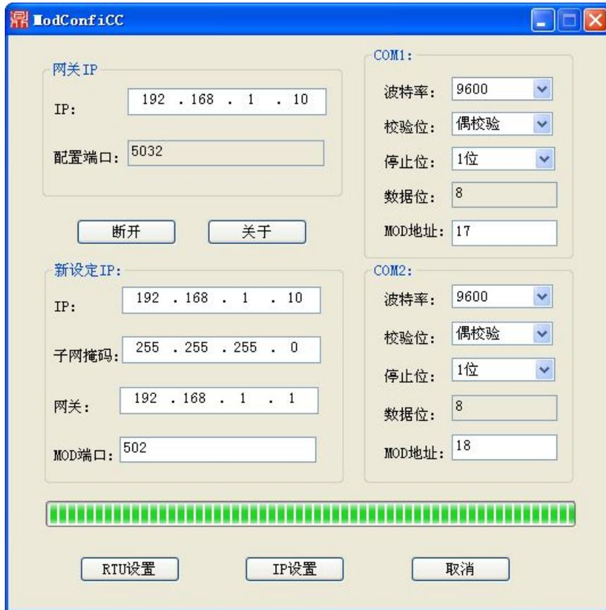
确认无误，点击“断开”，避免占用连接，网关已经可以正常使用。
