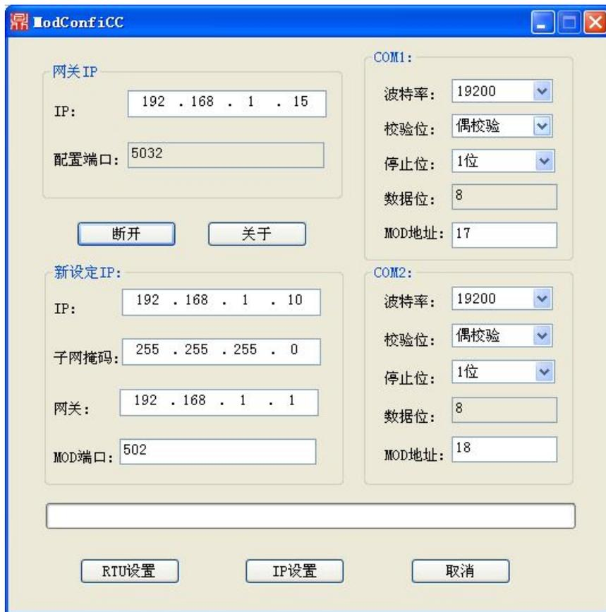
连接以后可以更改网关的 IP 地址，更改 COM1 和 COM2 的作为 MODBUS 从站的参数（波特率，校验位，停止位，MODBUS 站地址）；更改好参数后，如果修改了串口参数点击“RTU 设置”，设定了自定义的 IP 地址，则点击“IP 设置”，若都有修改则需要分别设置，顺序不分先后。
